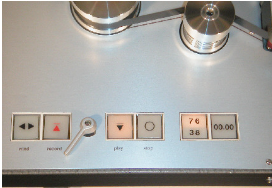
Abbildung 5: Telefunken M15a - Bedienleiste
